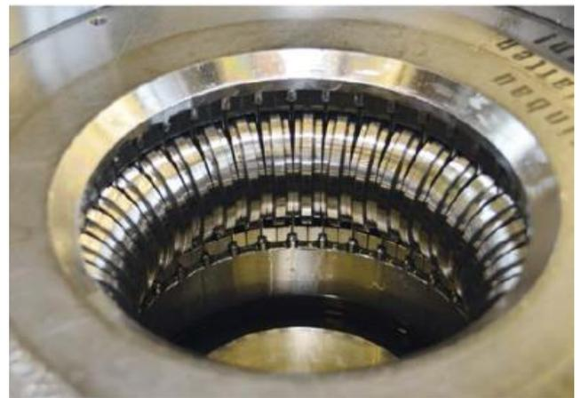
**Fürs Rollen:** Durch diese Rollwerkzeuge werden die gezogenen Töpfe durchgedrückt. Webo fertigt sie aus Spezial-Werkzeugstahl mit PVD\_Beschichtung. (Bilder: Schröder)
