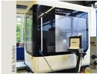
**Fräsen mit DMG:** Es wird ausschließlich mit modernen 5-Achs-BAZ gearbeitet. Mit dem Hersteller läuft auch Entwicklungsarbeit, z.B. probiert Web Sonderlösungen aus
