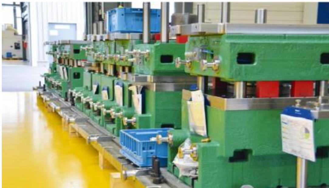
**Werkzeugsatz:** Lamellenträgerwerkzeuge bestehen aus bis zu 24 Stufen, die erst in der Montage aufeinandertreffen. Jede Stufe läuft als Einzelgewerk durch die Produktion.
